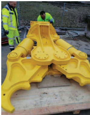
Testování prototypu hydraulických nůžek Epiroc řady CB
